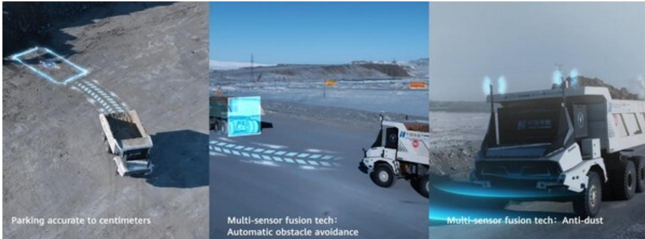
华为云商专车"车云协同"的无人驾驶全栈方案，在车端，融合了多种传感器的感知能力，可以在大风扬尘40m能见度的极端天气、夜间环境持续作业；在电离层异常等各种干扰下能够保障定位精度、鲁棒性和实时性；根据实时道路环境，精准规划路径并控制车辆，适应各种复杂的路况并自动绕过障碍物。在云端，提供车队调度管理系统、自动驾驶监管服务及动态业务地图云服务。在进行300+车辆智能调度及辅助车辆协同作业的同时，结合车辆任务、位置以及道路轨迹等信息综合加权计算，有效避免行驶拥堵，达到车铲资源的动态最优配置，实现车队的高效通行，多编组整体效率最优；监管平台对车辆软硬件运行状态全方位实时监管，支持车辆健康自检，故障告警，故障分析等，使得问题能够提前预警和及时恢复。并通过生产数据智能分析，预测趋势和调整策略；矿山道路变化较快，高精度业务地图可实现分钟级动态更新，实现作业区的精准对位，无需运营人员手动调整。通过车+云多系统联合优化，无人驾驶常态化作业效率最高可达人工驾驶作业效率的135%。
